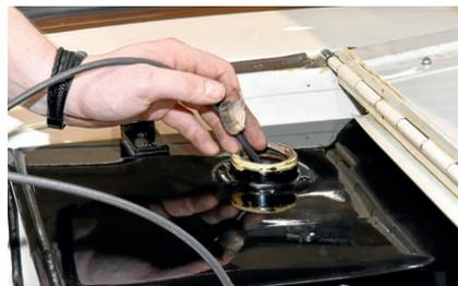
**Über den Tankeinfüllstutzen wird das Endoskop eingeführt**
