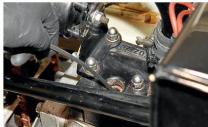
**Einführung der Videoskopiesonde über die Zündkerzenbohrung**
