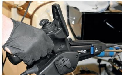
**Handheld-Bedienteil mit Joystick zur Steuerung der Videoskopkamera**
