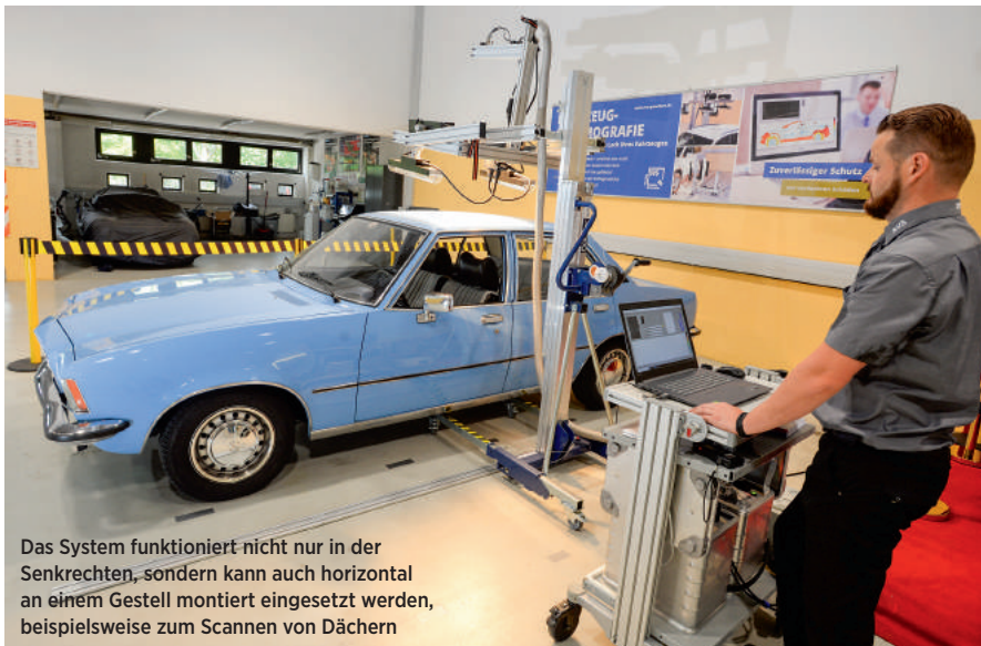
Die Apparatur besteht lediglich aus zwei Lampen, zwei Blitzgeräten und einem motorbetriebenen Schlitten
