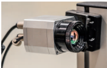
Unscheinbar: Das wichtigste Teil ist jedoch die Wärmebildkamera, welche die Temperaturunterschiede aufzeichnet
