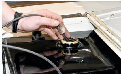
**Über den Tankeinfüllstutzen wird das Endoskop eingeführt**
