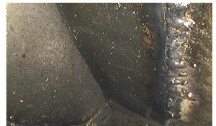
**Endoskopieaufnahme einer Schweißnaht**
